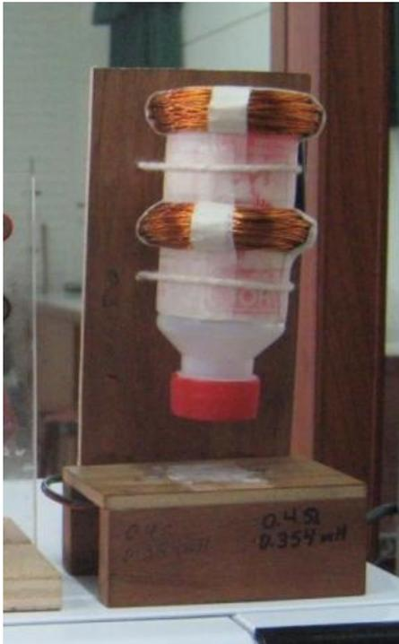
**Fotografía N°1** Bobina de Campo Magnético tipo Helmholtz diseñada por el Profesor Ivan Ramirez J. en el Laboratorio de Física Aplicada de la Facultad de Ciencias Biológicas.
