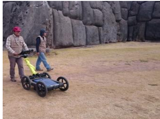
Fotografía N° 01: Medición con el equipo de Georadar.
