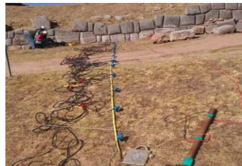
Fotografía N° 02 Vista del ensayo de Refracción Sísmica.
