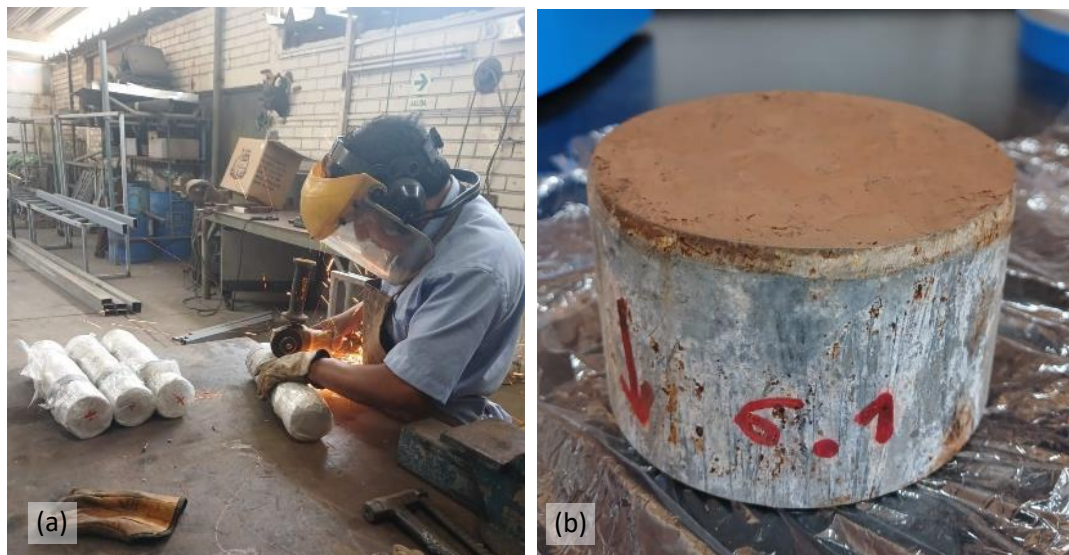
Figura N°15: (a) Corte de tubos de con muestra de suelo (b) Vista de cuerpo de prueba, listo para ser ensayado
