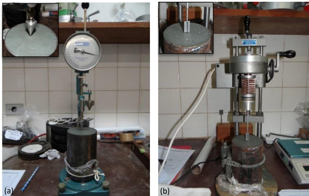
Figura N°07: Calibración del Penetrómetro de Cono mediante la comparación de resultados obtenidos con el ensayo de veleta de laboratorio (a) Ensayos realizados con el Penetrómetro de Cono, (b) Ensayo realizado con veleta de laboratorio (Lemos, S, 2014)
