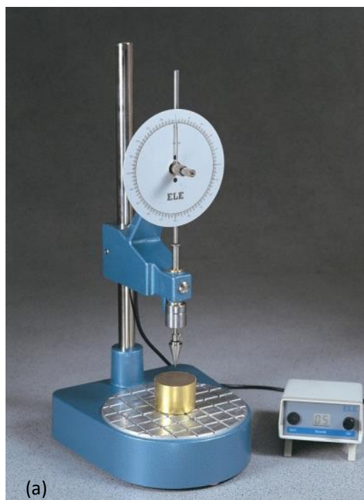
Figura N°05: Penetrómetro de Cono (a) Vista general, (b) Ilustración esquemática
