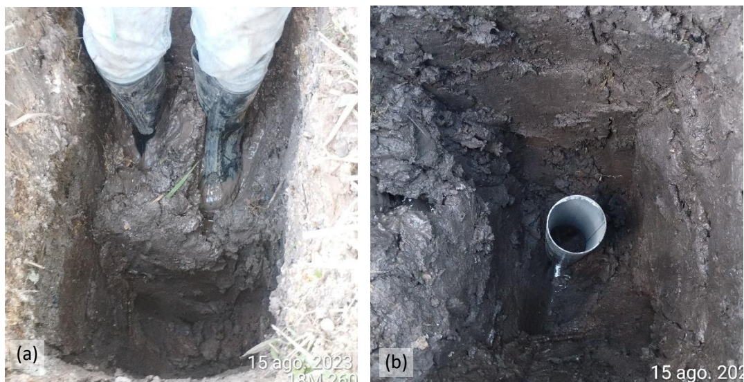
Figura N°14: (a) Vista de interior de calicata, realizada para extracción de muestra (b) Tubo de pared delgada, utilizado para extracción de muestras inalteradas
