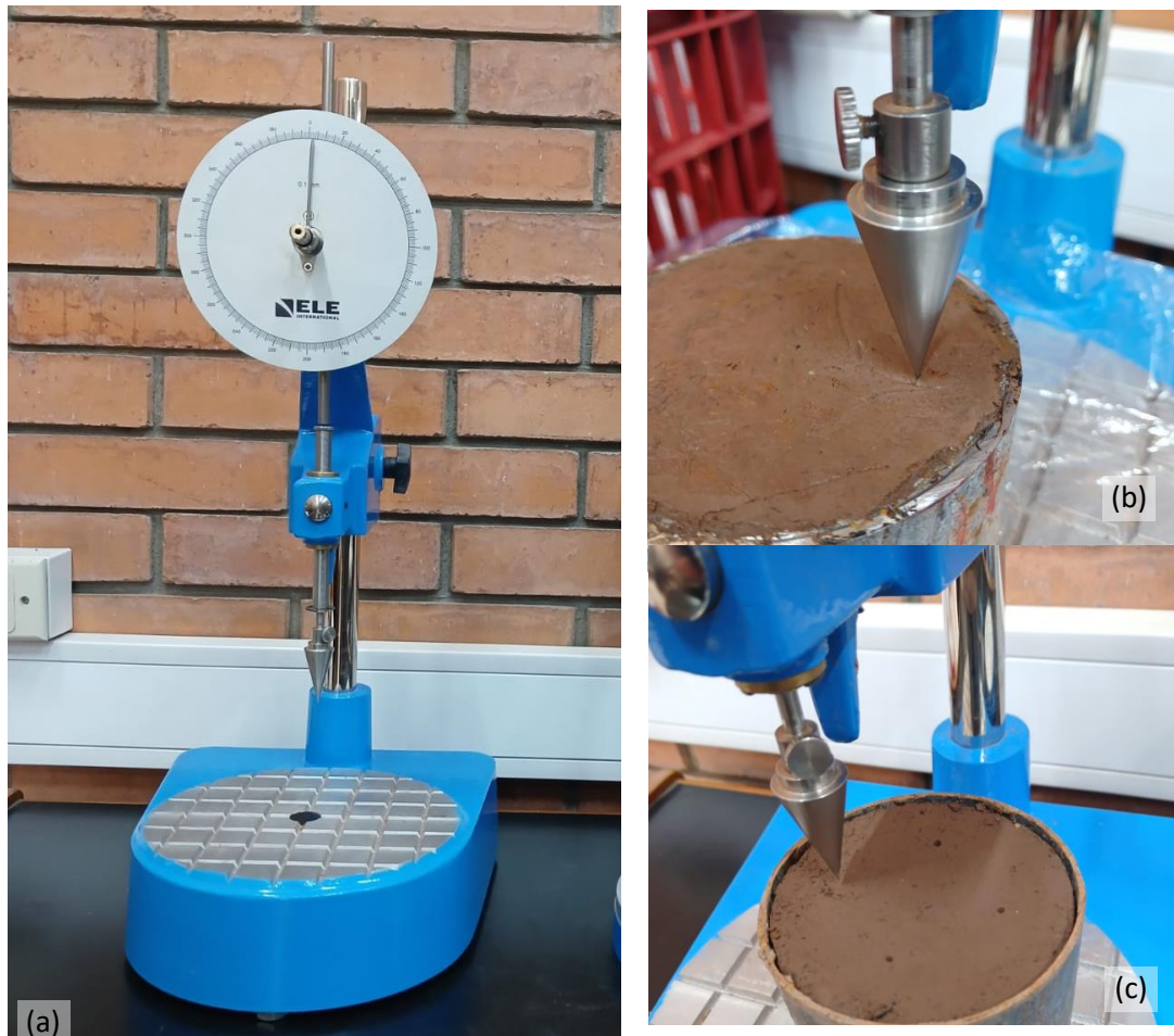
Figura N°16: (a) Equipo Penetrómetro de cono, (b) Posición del cono antes de ensayo (c) Ejecución de ensayo en cuatro puntos equidistantes
