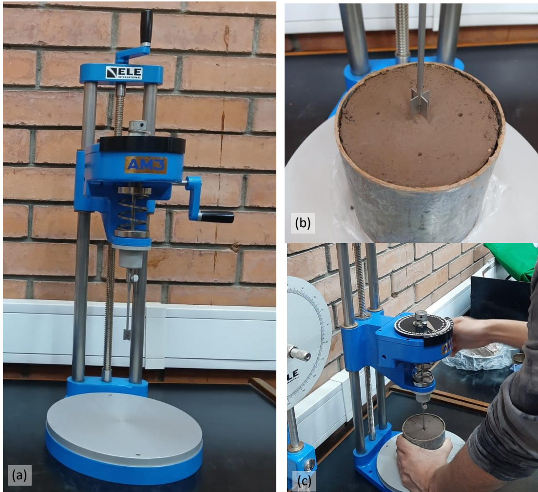
Figura N°17: (a) Equipo Veleta de Laboratorio, (b) Posición de la veleta antes de ensayo (c) Ejecución de ensayo en el centro del cuerpo de prueba
