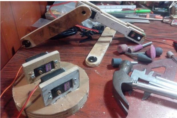
Figura 4. Servomotores instalados en las articulaciones
