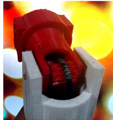
Fig. 4. Codo del brazo robótico impreso en 3D.
