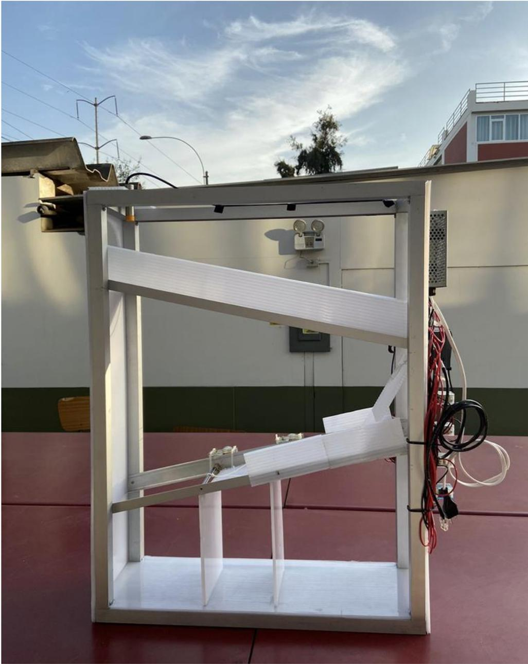
Figura 30: Máquina clasificadora de residuos
