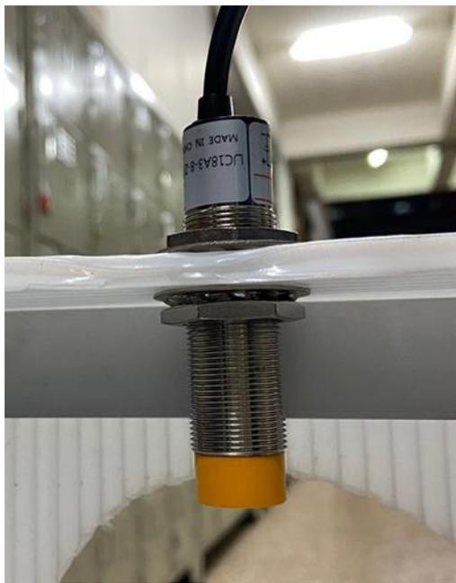
Figura 06: Sensor Capacitivo
