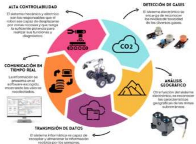
Fig.3 Diagrama mecatrónico de un robot móvil autónomo
