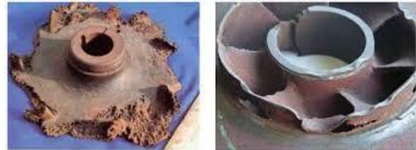
EROSION CREADA POR CAVITACION EN ROTORES DE BOMBAS CENTRIFUGAS
