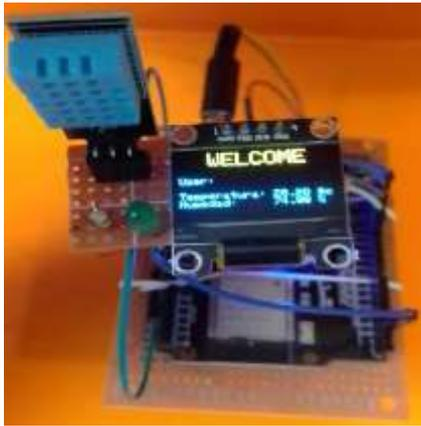
El módulo calcula los valores emitidos por el DHT y los manda constantemente al APP, y sólo cuando se acciona el botón, el ESP32 recibe una señal para encender el LED.
