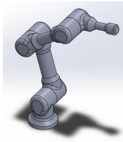
Fig. 10 Robot Manipulador de 5 DOF
