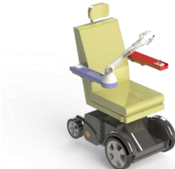
Figura 1: Brazo robótico adaptado una silla de ruedas eléctrica
