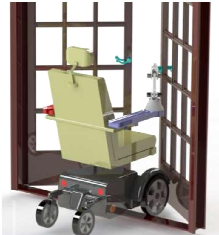
Figura 17: Interacción del brazo robótico con la perilla de una puerta
