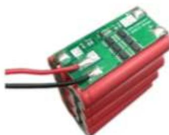
Figura 12: Pack de baterías de Li-ion de 7.4 V a 10Ah
