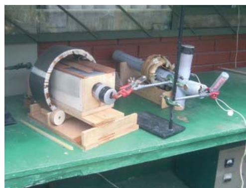
Fotografía 2: Bobina de 22 cm. de radio albergando la casa de madera de reproducción
