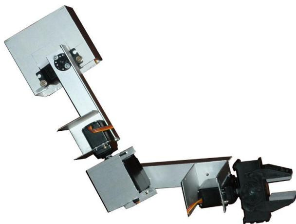
Fig. 4 Brazo robótico de 5 grados de libertad: servomotores y armazones de metales y plástico
