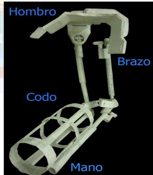
Fig. 5 Mecanismo adaptable al brazo humano: Diseñado el brazo del usuario con sensores y mando de control
