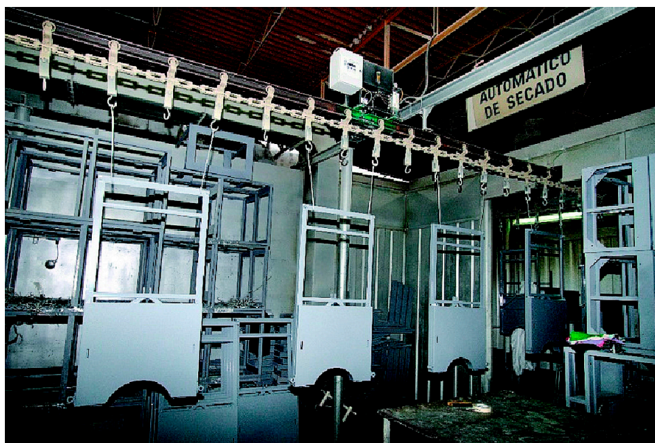
Figura 34. Horno de secado de baja eficiencia
