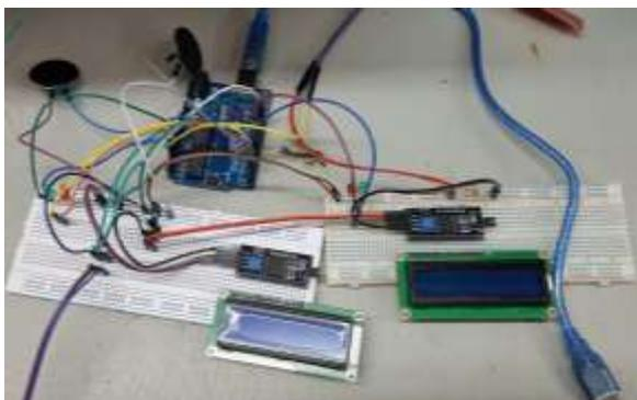
Fig. 1. Conexiones de los sensores de combustible y temperatura.
