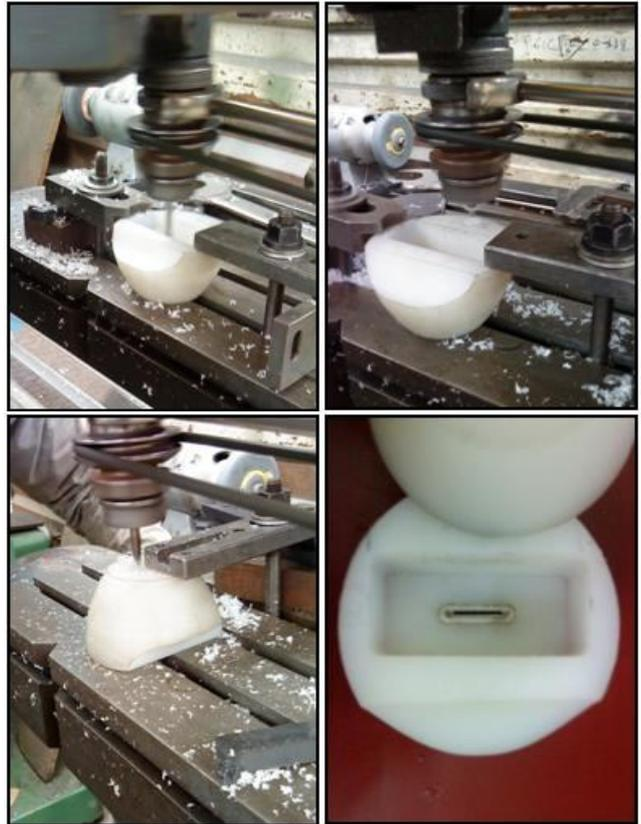
Figura 12: Maquinado del nylon en pantógrafo.
