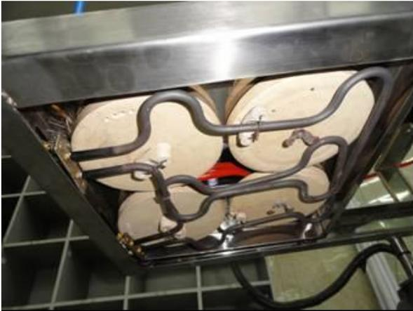
**Figura 3:** Sistema de calentamiento con resistencias - vista inferior
