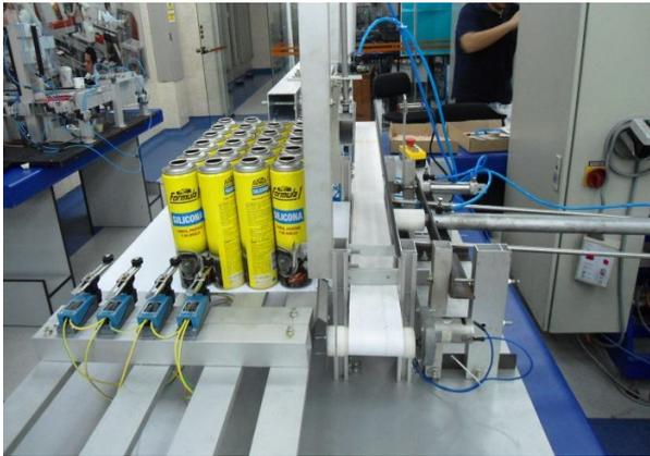
Fig. 7. Vista lateral del prototipo de máquina acopiadora de latas
