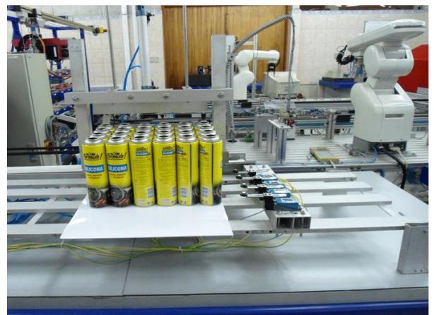
Fig. 6.: Vista frontal del prototipo de maquina acopiadora de latas
