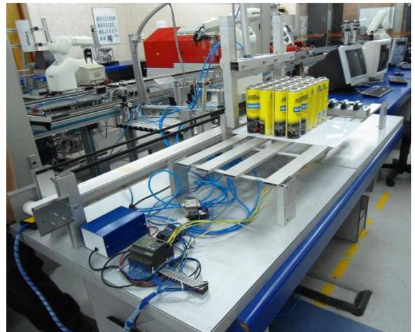
Fig. 5: Prototipo de maquina acopiadora de latas
