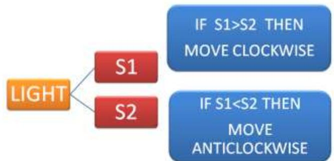
Figura 6. Lógica de control del sentido de giro del motor
