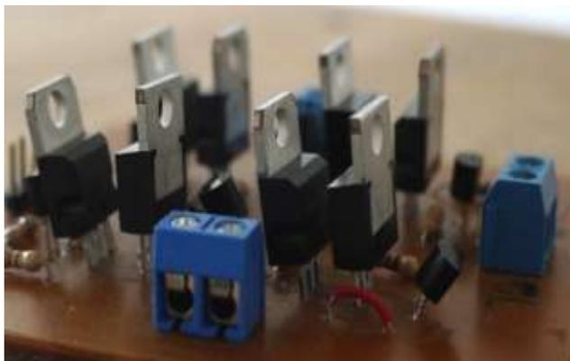
Figura 11. Tarjeta del Puente H
