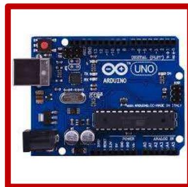
Figura 1. Placa Arduino UNO
