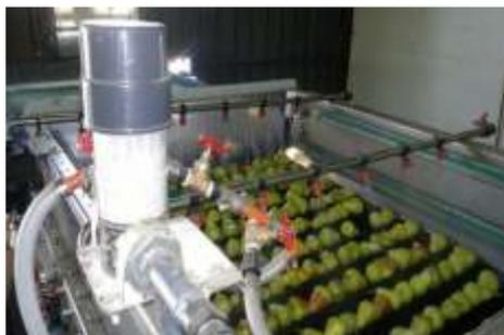
Figura 2. Sistema de lavado para manzanas
