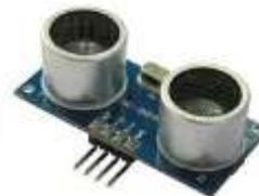
Figura N°5. Sensor ultrasónico
