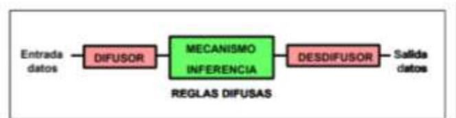
Figura N°1 Esquema general de un sistema difuso
