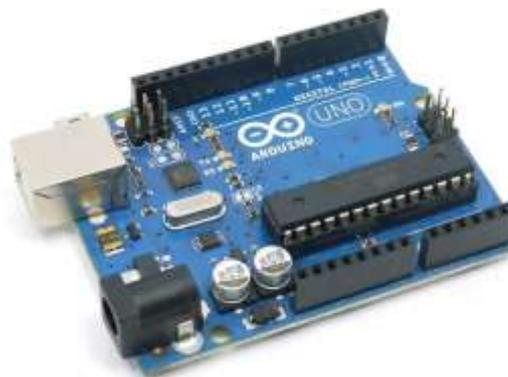
Figura N°4. Arduino Uno
