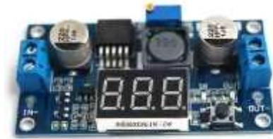
Figura 9: Regulador de voltaje Step down [10]
