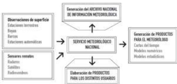
Figura1: Eslabones que componen el recorrido y procesamiento de la información meteorológica. [1]
