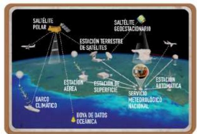
Figura 2. Componentes de la Red Mundial de Observación [1]
